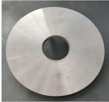
Gbr. 5 Heater (Diameter luar = 15,6 cm, Diameter dalam = 4 cm, dan Tegangan = 220 V/400 W)
