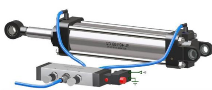
Gbr. 11 Konfigurasi perencanaan pin antara solenoid valve pada silinder pneumatik ke Arduino
