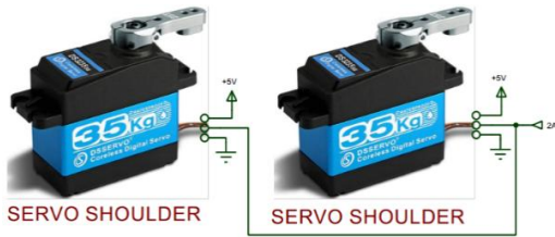
Gbr. 10 Konfigurasi Perencanaan Pin Motor Servo Shoulder, Base, Elbow dan Wriste
