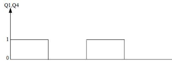
Gbr. 2 Bentuk Gelombang Sinyal pada Sakelar Siklus Positif
