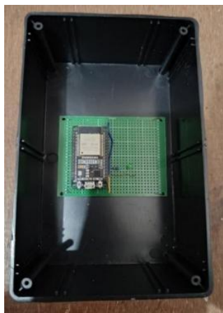
Gbr. 4 Tampak Dalam Box untuk Gateway
