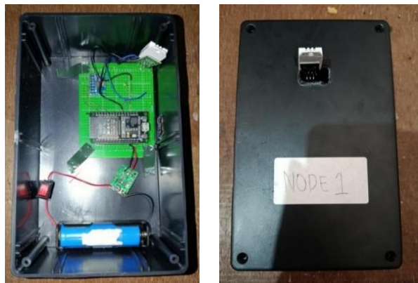
Gbr. 3 Implementasi Hardware: Node Sensor (a) Tampak Dalam; (b) Tampak Luar
