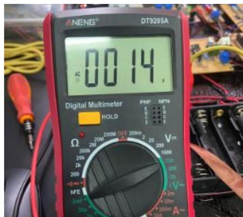
Gbr. 9 Nilai Tegangan Output pada Rangkaian Inverter
